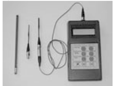
Rys. 2. a) stanowisko wzorcowych pól magnetostacyjnych, stosowane w CIOP, do badania teslomierzy hallotronowych, b) teslomierz hallotronowy
