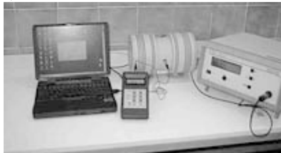
Rys. 2. a) stanowisko wzorcowych pól magnetostacyjnych, stosowane w CIOP, do badania teslomierzy hallotronowych, b) teslomierz hallotronowy
