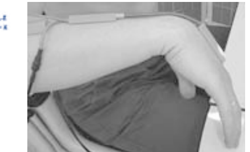
Rys. 3. Schemat pracy goniometrów oraz przykład umieszczenia goniometrów na kończynie górnej osoby badanej
