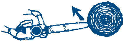
Rys. 2. Niedozwolone cięcie końcówką prowadnicy pilarki łańcuchowej
