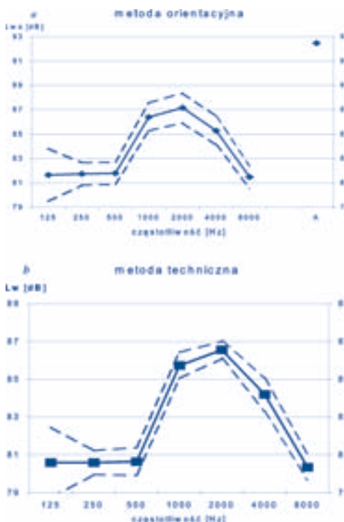
Rys. 6. Poziomy mocy akustycznej (wraz z odchyleniem standardowym odtwarzalności wyników badań) w pasmach oktaowych oraz skorygowany poziom mocy akustycznej A wzorcowego źródła dźwięku wyznaczone metodami: a – orientacyjną, b – techniczną
