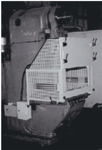
Rys. 4. Osłona ruchoma na prasie mimośrodowej
