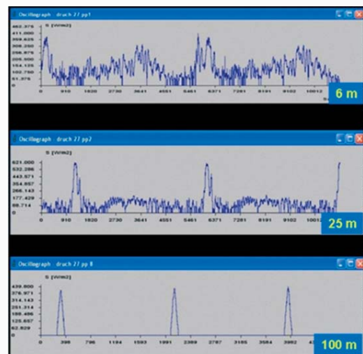
Rys. 2. Wartości chwilowe natężenia pola elektrycznego w pionach pomiarowych umieszczonych w odległościach 6, 25 i 100 m od osi anteny odległościomierza
