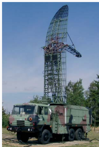
Rys. 2. Widok ogólny wysokościomierza
