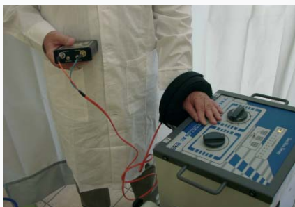
Rys. Z4. Przykład wykorzystania miernika indukcyjnego ( clamp-on ) do pomiaru prądu dłoni na nadgarstku pracownika dotykającego pulpitu generatora diatermii krótkofalowej Fig. Z4. The example of the use of inductive meter ( clamp-on ) for the measurements of the palm current on the wrist of worker who touches the console of short-wave diathermia generator
