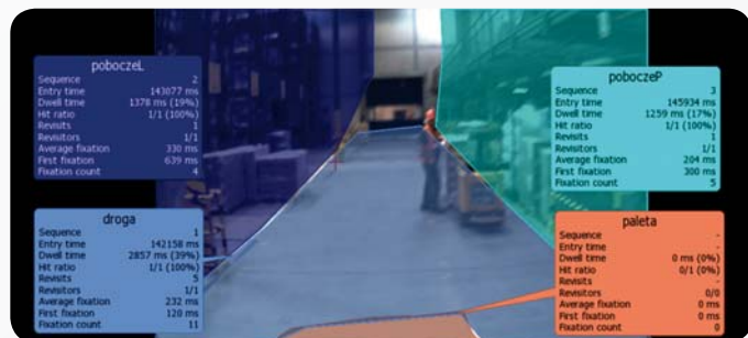
Rys. 2. Schemat obserwacji przez operatora pola widzenia przed wózkiem podczas jazdy na wprost z podziałem na obszary zainteresowania
