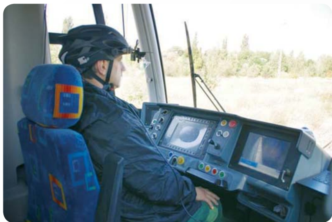
Fot. 1. Motorniczy podczas badania pola widzenia z zastosowaniem okulografu przenośnego
