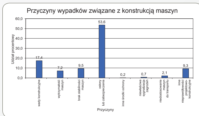
Rys. 2. Udział procentowy wypadków z przyczyn związanych z konstrukcją maszyn Źródło: opracowanie własne na podstawie bazy danych KRUS za 2010 r.
