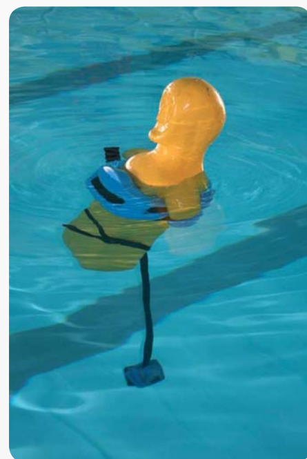
Fot. 4. Ustawienie i obciążenie manekina w czasie prób z kołem ratunkowym Photo 4. Setting up and loading a manikin during tests with a life belt
