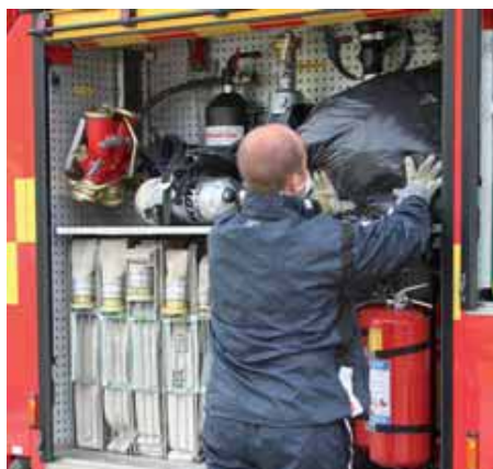
Transport zanieczyszczonych ubrań – przewożone ubrania są oddzielone od strażaków
