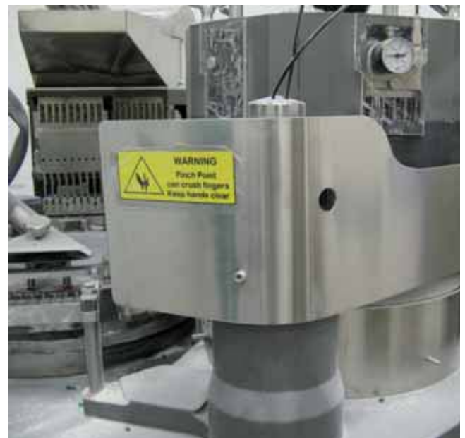
Nowe osłony ochraniające ruchome części maszyny
