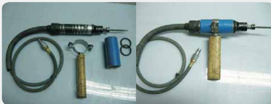
Fot. 8. Pilnik z nową osłoną i drewnianym uchwytem
