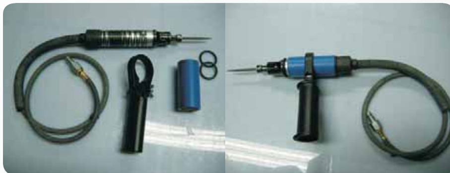
Fot. 9. Pilnik z nową osłoną i profesjonalną rączką Photo 9. Pneumatic file with new cover and professional handle
