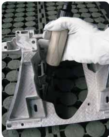
Fot. 1. Gradowanie w rękawicy roboczej Photo 1. Deburring in working glove
