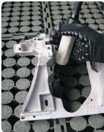
Fot. 2. Gradowanie w rękawicy antywibracyjnej Photo 2. Deburring in anti-vibration glove
