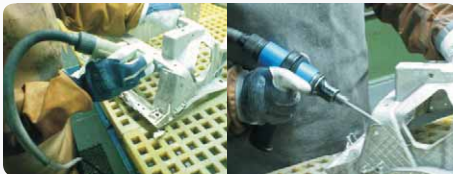
Fot. 10. Sposób gradowania przed i po modernizacji Photo 10. Means of deburring before and after modernization
