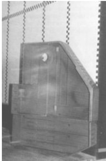
Rys. 11. Oryginalny element korpusu tokarki - dwuczęściowa osłona łańcuchów kinematycznych napędowych - strona wewnętrzna
