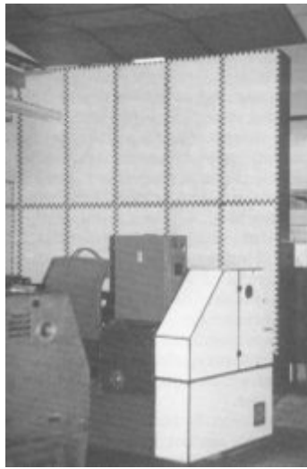
Rys. 5. Tokarka uniwersalna CU 585 HEMUS z zastosowaną obudową zintegrowaną (widok z tyłu), w tle elementy przemysłowej adaptacji akustycznej
