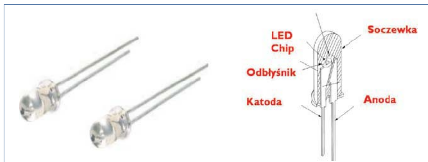
Rys. 1. Świecące diody wskaźnikowe o mocy 100 mW
