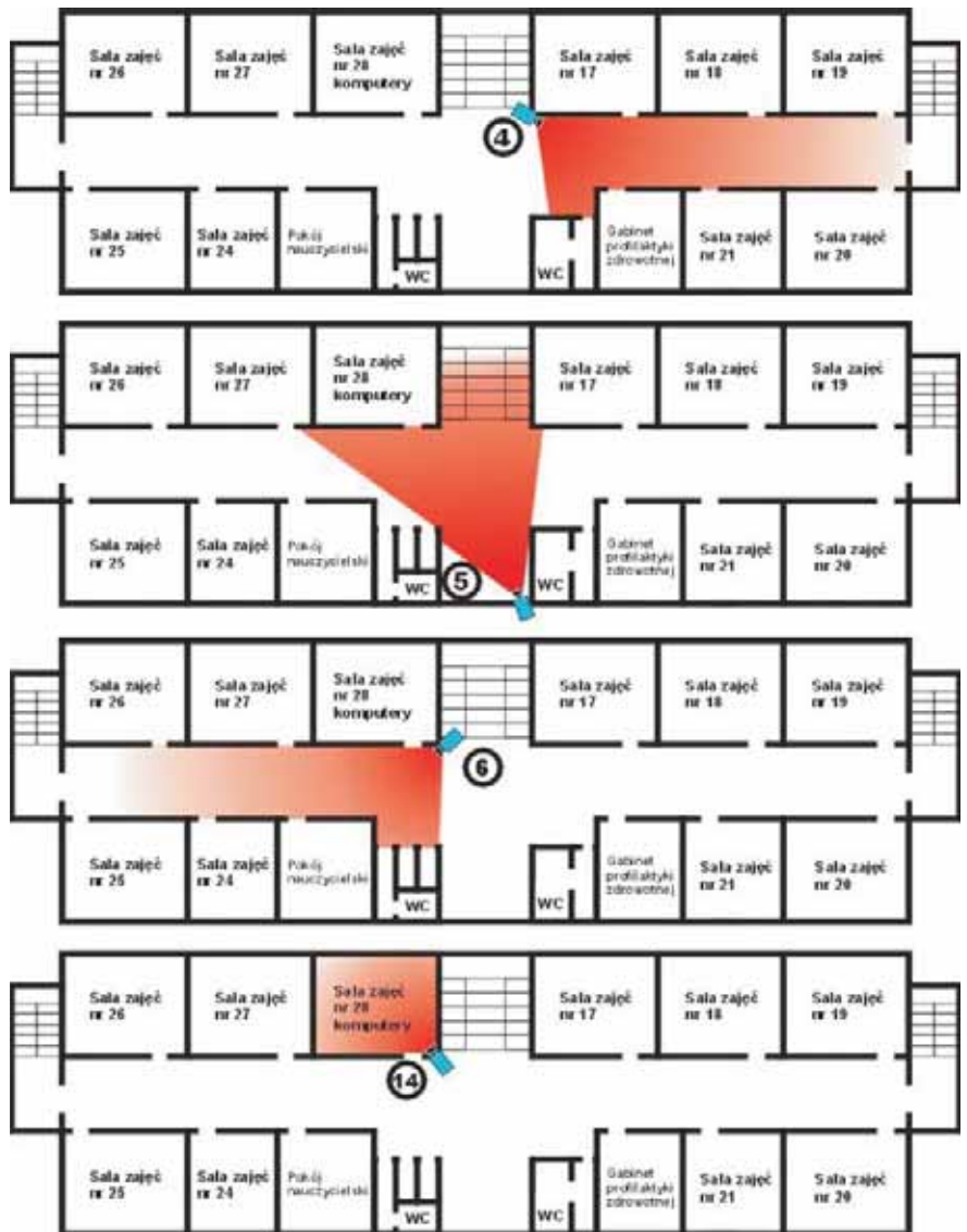
Rys. 1. Obszar widzenia kamer na poziomie I piętra Fig. 1. Vision range of camera on the level of the first floor
