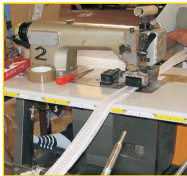
Fot. 3. Stanowisko obsługi maszyny do konfekcjonowania (maszyna do wycinania pasmanterii) Photo. 3. A workstation of an operator of a machine for cutting haberdashery
