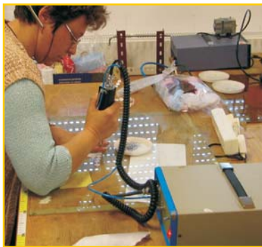
Fot. 2. Stanowisko obsługi maszyny do konfekcjonowania (maszyna do nanoszenia aplikacji w materiał – wtapianie kryształków w materiał) Photo. 2. A workstation of an operator of a machine for applying diamond appliques onto fabric
