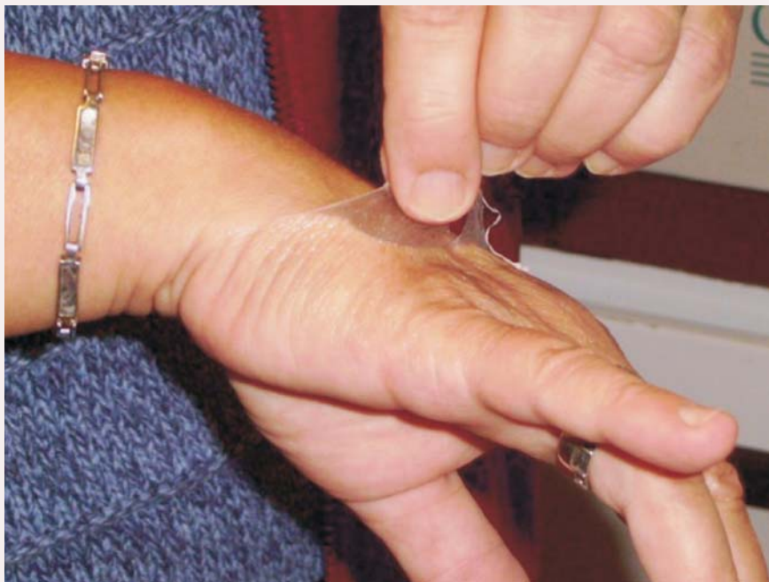
Elastyczna, nie lepka błona uzyskana z żelu wytworzonego z poli(alkoholu winylowego) Non-sticky, elastic membrane made of gel based on polyvinyl alcohol
