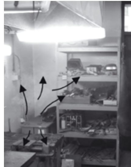
Fot. 2. Wizualizacja przepływu dymu na stanowisku pracy w badanym pomieszczeniu, gdy system wychwytywania zanieczyszczeń był włączony
