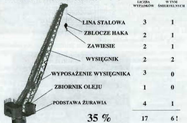
Rys. 1. Techniczne przyczyny wypadków na dźwigach oceanotechnicznych [11]
