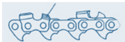
Rys. 5. Piła łańcuchowa z wyprofilowanym ogranicznikiem zagłębienia ogniwa tnącego (ogranicznik zagłębienia jest lekko pochylony i bardziej wysunięty ku przodowi)
