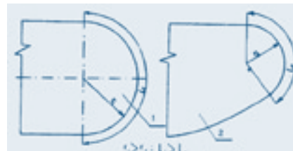
Rys. 9. Końcówki przewodnicy piły łańcuchowej: 1 – standardowa; 2 – o mniejszym promieniu zaokrąglenia
