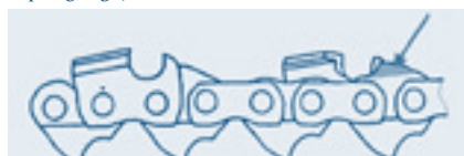
Rys. 7. Piła łańcuchowa z podwyższonym ogniwiem prowadzącym (ogniwo prowadzące ma podwyższoną wysokość, jego część przednia jest szlifowana a część tylna wydłużona aż do ogranicznika zagłębienia)
