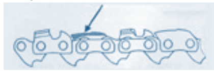
Rys. 6. Piła łańcuchowa ze specjalnym kształtem ogniwa łączącego (ogniwo łączące ma podwyższoną wysokość, jego część tylna wydłużona aż do ogranicznika zagłębienia)
