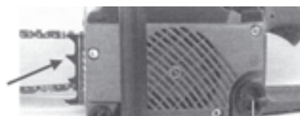
Fot. 5. Zderzak oporowy zębaty pilarki łańcuchowej
