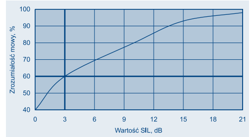
Rys. 5. Relacje pomiędzy wartościami procentowej zrozumiałości mowy i wartościami SIL
