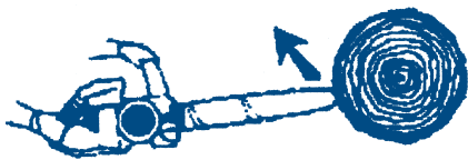
Rys. 2. Niedozwolone cięcie końcówką prowadnicy pilarki łańcuchowej
