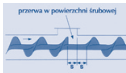
Rys. 2. Eliminacja zagrożenia zgnieciem lub obciążeniem przez zastosowanie przerwy S \geq 120 mm w powierzchni śrubowej przenośnika ślimakowego
