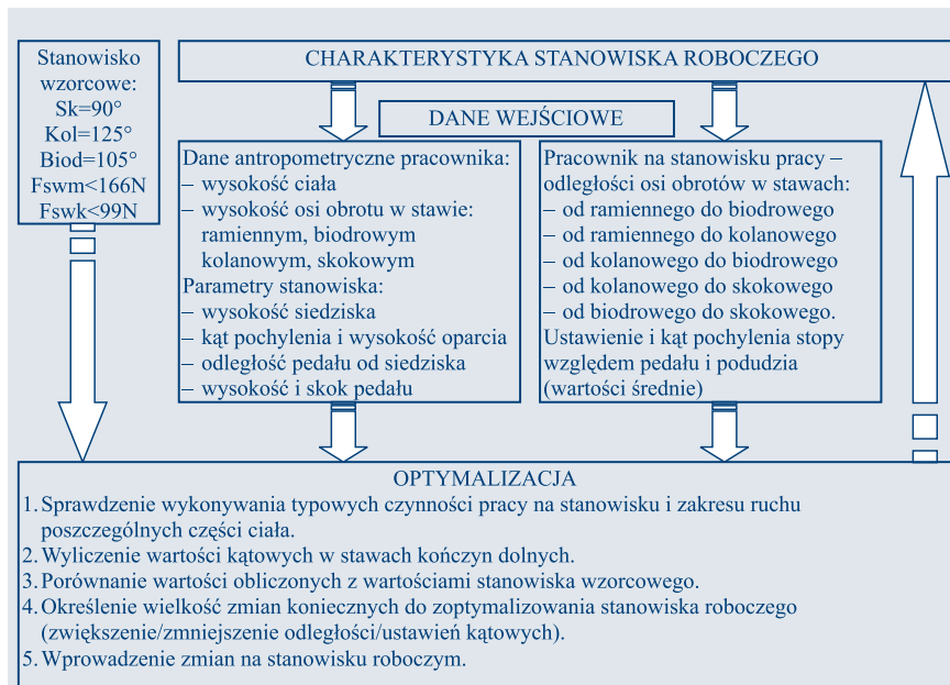
Rys. 2. Schemat optymalizacji położenia elementu sterowniczego na stanowiskach wyposażonych w pedały. Wartość kąta w stawie skokowo-goleniowym – Sk, kolanowym – Kol, biodrowym – Biod, wartość maksymalnej zalecanej siły na pedale dla mężczyzn – Fswm i kobiet – Fswk
